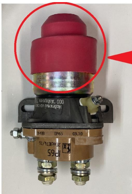
Дополнительное управляющее устройство главного выключателя аккумуляторной батареи (ГВАКБ)
