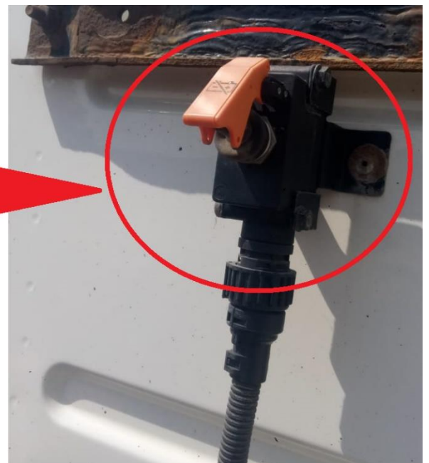
Дополнительное управляющее устройство главного выключателя аккумуляторной батареи (ГВАКБ)
